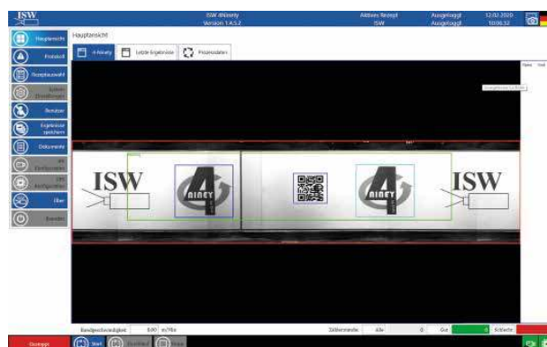
Zusammengesetzte abgewinkelte 360°-Aufnahme zur Code-Kontrolle eines rotationssymmetrischen Produktes.
