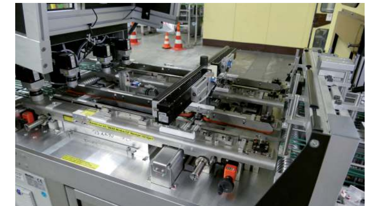
Bei geöffnetem Deckel sind der vordere ‚Line Scan Bar‘ (Bildmitte unten), die beiden darüber angebrachten CCS-Beleuchtungen sowie links die vier Nano-Kameras erkennbar.
