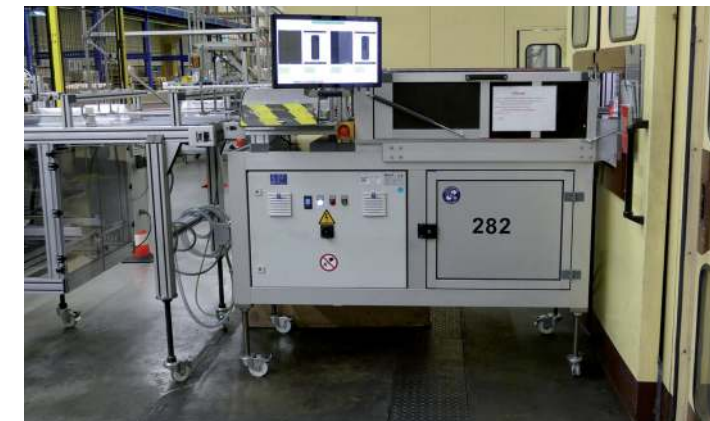
Ein zweistufiges Bildverarbeitungssystem untersucht die produzierten Schalen zu 100 % auf Dichtigkeit und Konturtreue.
